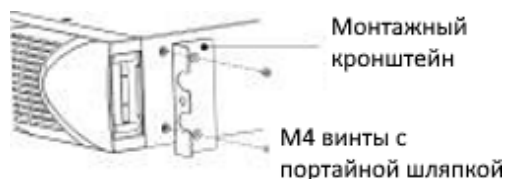
Рисунок 6 – Установка монтажных кронштейнов
