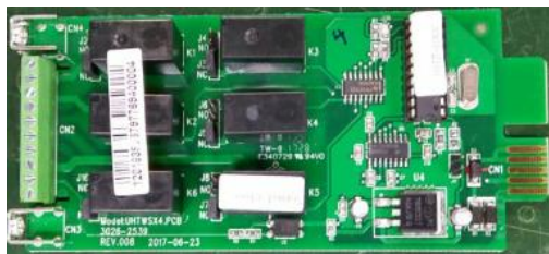
Внешний вид платы сухих контактов
