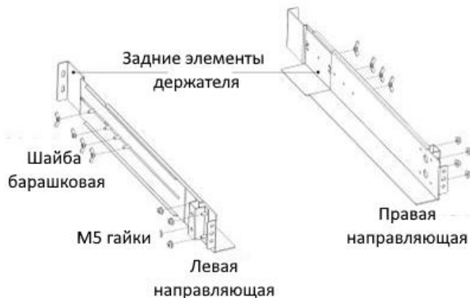
Рисунок 3.1 – Крепление монтажного комплекта рельс
