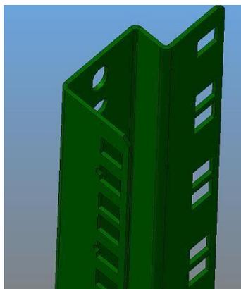
Дно и крыша шкафа имеют рамную конструкцию и соединяются между собой вертикальными стойками. Передние и задние стойки в свою очередь, соединяются друг с другом двумя горизонтальными направляющими, к которым крепятся монтажные профили.
