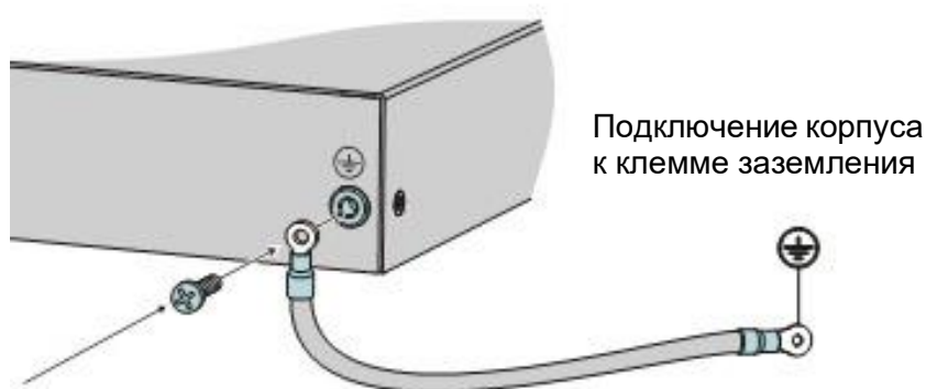
Рисунок 3-6. Подключение корпуса к клемме заземления
