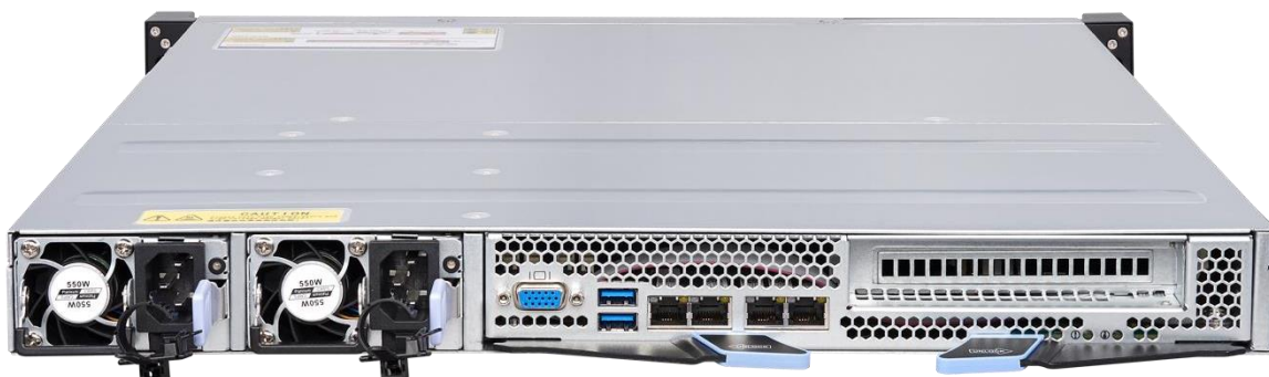
Рисунок 1. Серверная платформа QSRV-130404 (Вид сзади)
