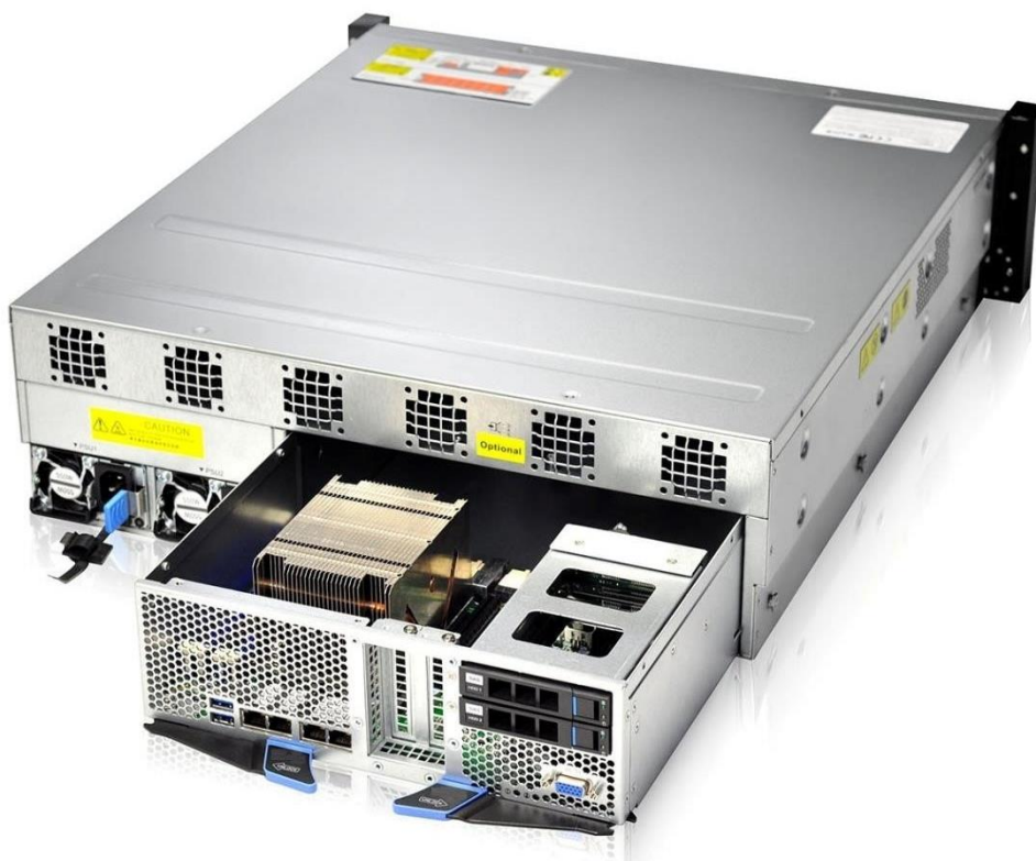
Рисунок 2. Серверная платформа QSRV-331604 (вид сверху)
