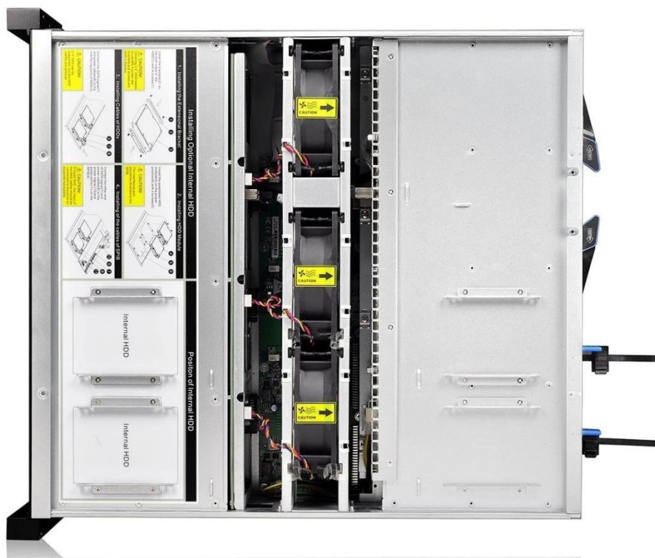
Рисунок 2. Серверная платформа QSRV-332404 (вид сверху)
