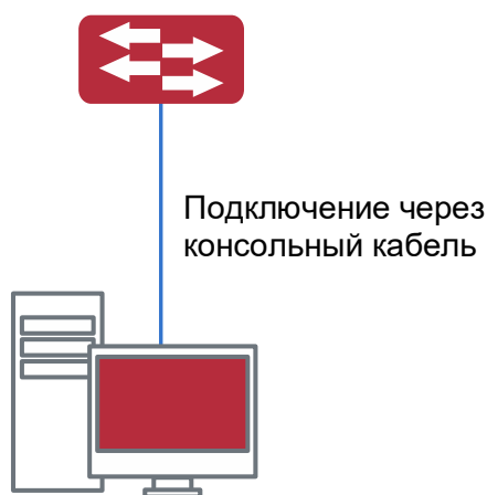
Рисунок 1. Подключение ПК к консольному порту коммутатора
