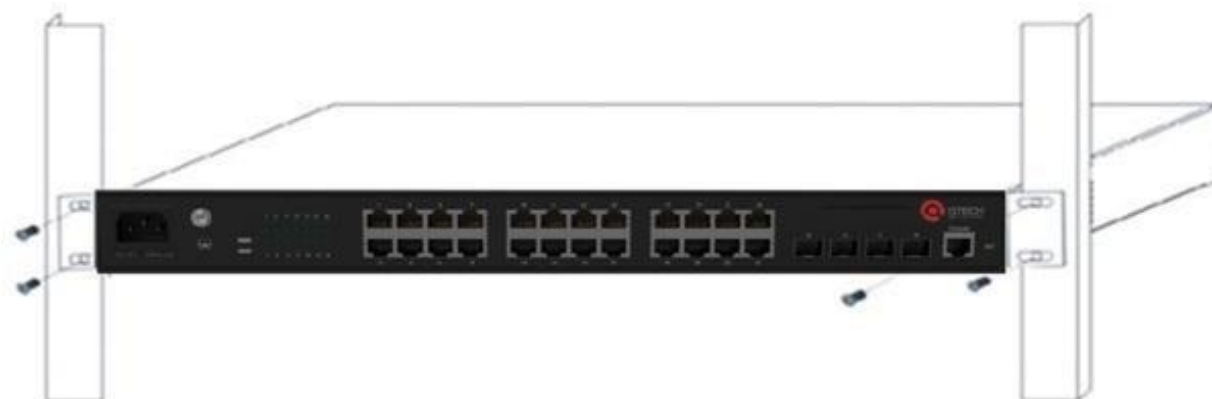
Рисунок 2-2. Установка коммутатора в стойку
