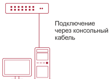
Рисунок 4-2. Подключение ПК к консольному порту коммутатора
