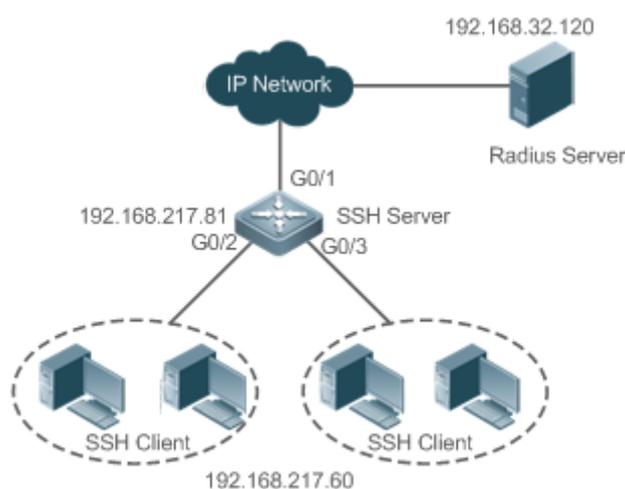
Рисунок 7-3. Сетевая топология аутентификации SSH AAA
