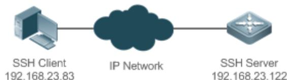
Рисунок 7-4. Топология сети для аутентификации пользователей SSH с помощью открытого ключа
