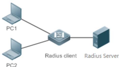
Рисунок 2-1. Типичная топология сети RADIUS
