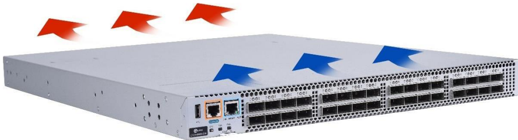
Рисунок 1-5. Тепловыделение и вентиляция QSW-6900-32H
