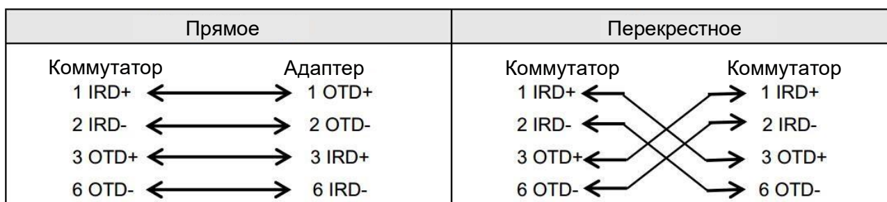
Рисунок 7-2. Соединения пинов разъема и витой пары для портов 100 BASE-TX/10 BASE-T
