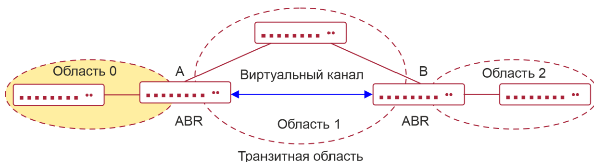
Рисунок 4-5. Невозможность прямого подключения обычной области к магистральной области физической сети
