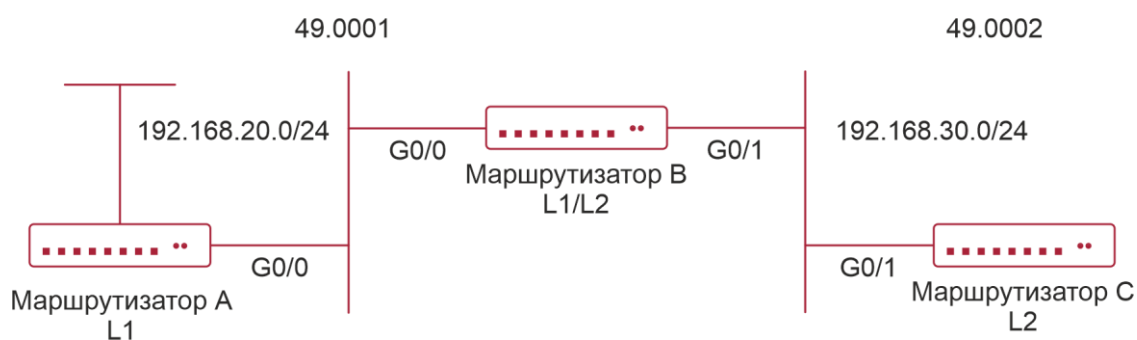
Рисунок 6-13. Топология аутентификации IS-IS
