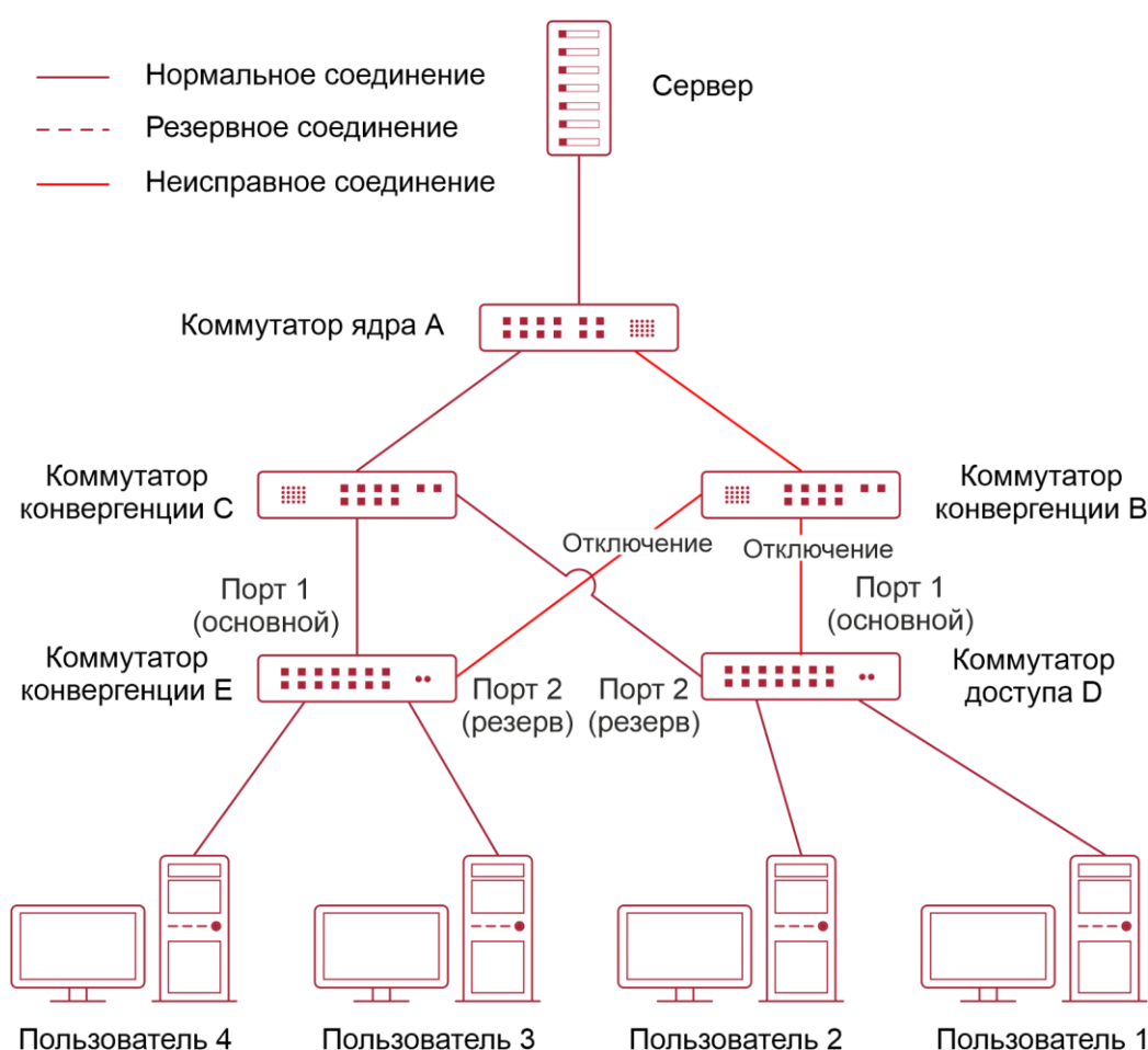
Рисунок 1-5. Топология, в которой upstream-канал активного канала неисправен
