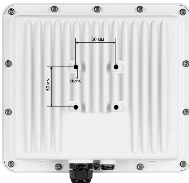
Рисунок 8-3. Посадочный размер корпуса
