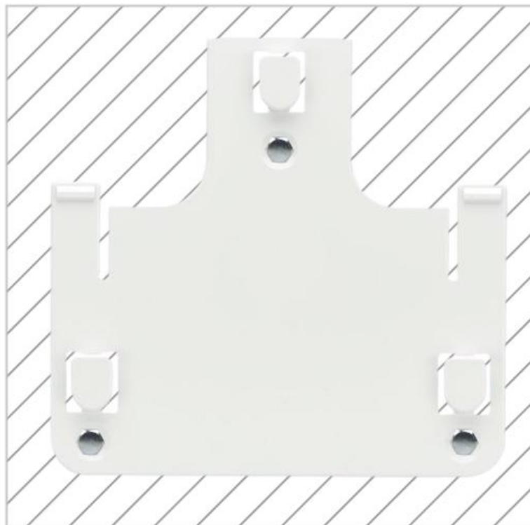
Рисунок 8-2-4. Монтаж в сквозное отверстие – вид сверху
